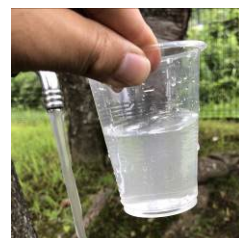
図1 水道水の白濁現象
