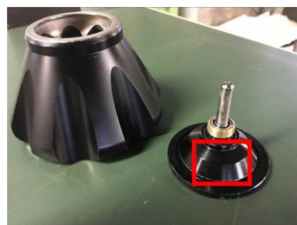
図 5 補修した上蓋ねじ
