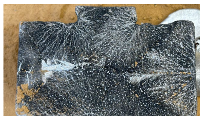
図2 消失模型鋳造法の鋳物内部
