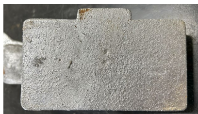
図1 砂型鋳造法の鋳物内部
