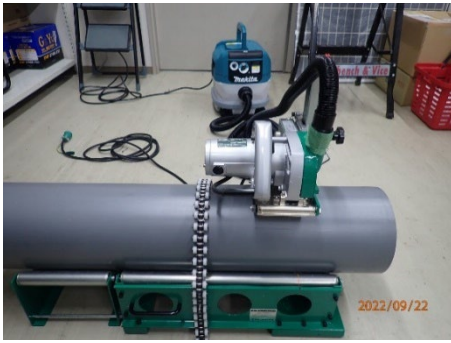
写真2 切断（塩ビカッター）
