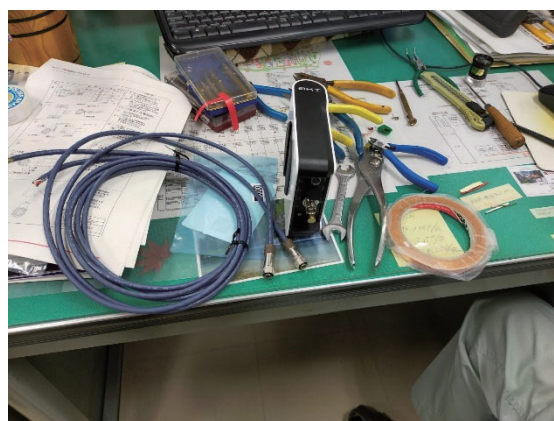
Figure 2 通信ケーブルの修理
