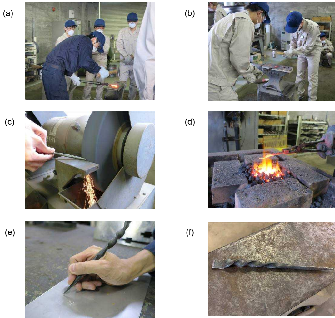
図3 実習風景 (a)製作工程の説明 (b)鍛造 (c)研削 (d)熱処理 (e)製品評価 (f)製作したケガキ針
