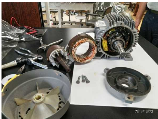
Figure 3 モーターの分解・組み立て
