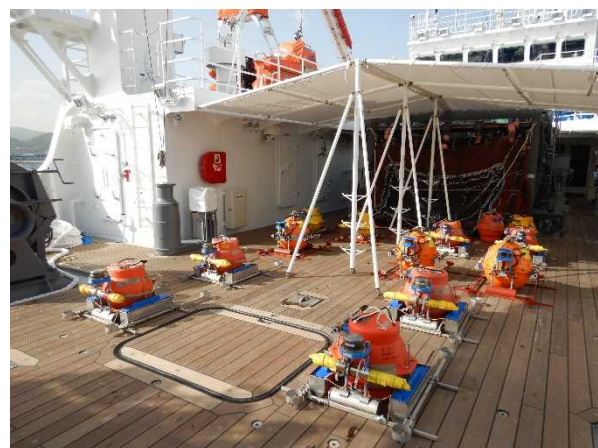
本航海で設置した各種海底地震計
