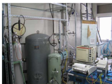
図1 流動層実験装置
