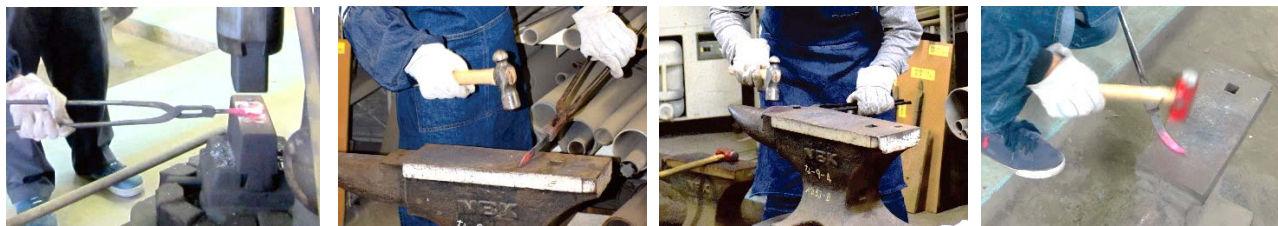
図 1 鍛造の各工程 左から鍛造の工程 1~4 となっている
