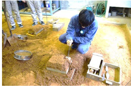
図4 スタンプで突き固める様子
