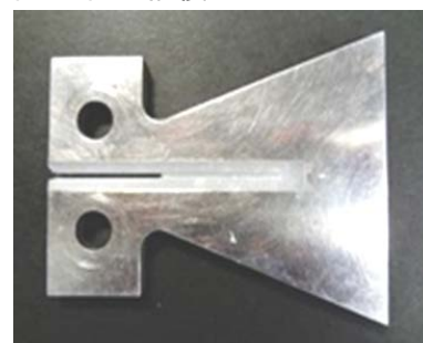
図 2.TDCB 試験片の形状と外観
