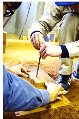
図5 下型から模型を抜く様子
