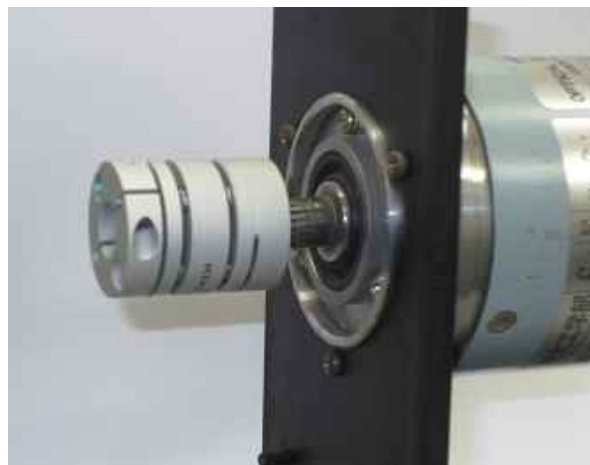
図 6 エンコーダに取り付けられたカップリング
