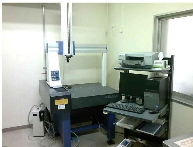
図 2: ミットヨ 三次元測定機 Crysta-Plus M544
