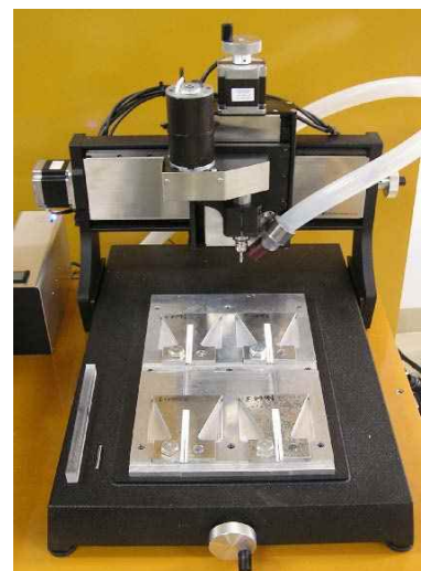
図 4. CNC フライス盤と治具に固定された試験片
