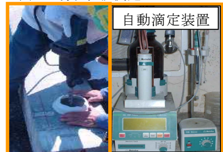
図-7 塩化物イオン濃度の分布の測定
