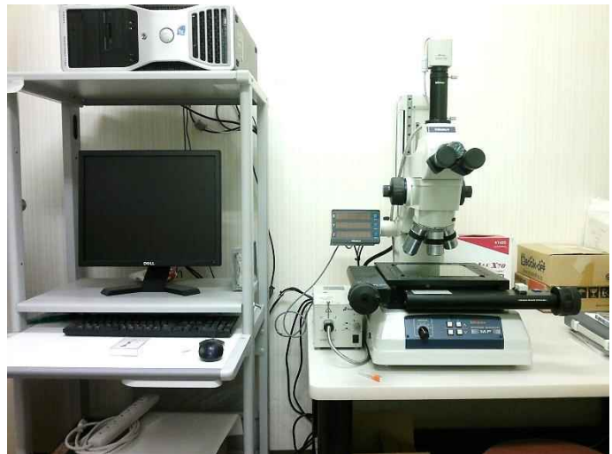
図1:ミットヨ 測定顕微鏡 MF-UD505B(画像ユニット付)
