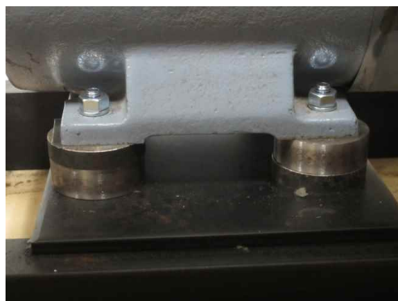
図 7 スペーサと敷金で高さ調整
