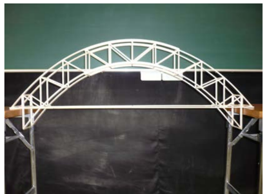
図-5 ブレースドリブタイドアーチ橋
