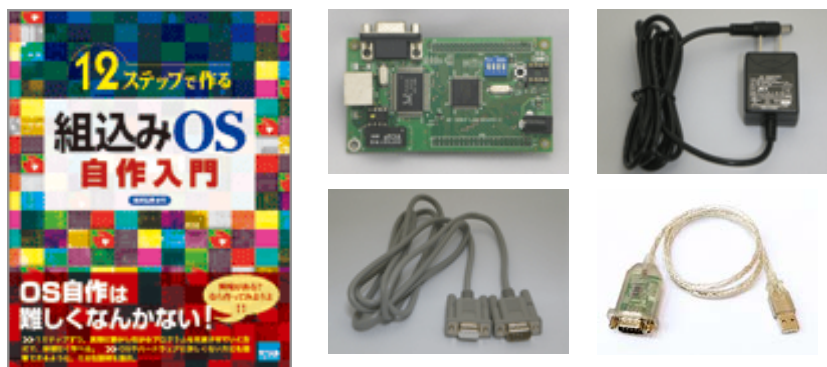
図1：教科書、マイコンボード、ACアダプタ、シリアルケーブル、USBシリアル変換器
