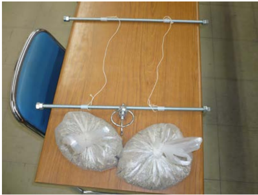
図-2 重り載せと砂袋による重り
