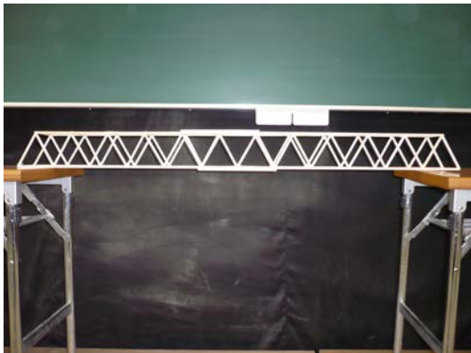
図-4 ワーレントラス橋
