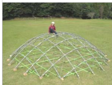
写真 2 ブレース挿入後のシェル
