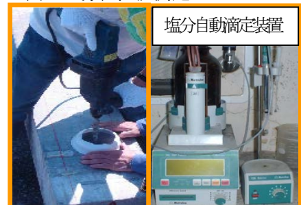
図-7 塩化物イオン濃度の分布の測定
