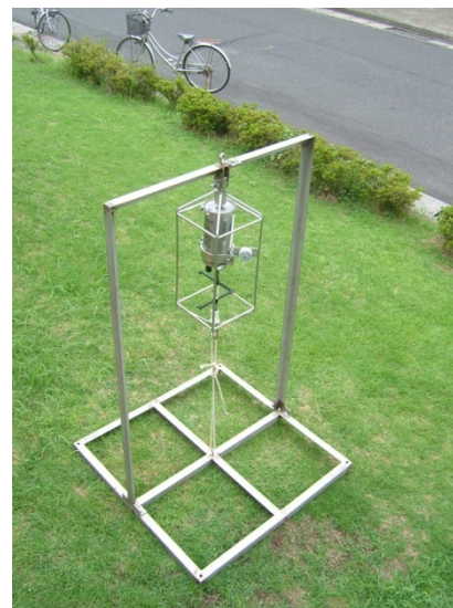
図-1 流速計固定用フレームと3D-ACM
